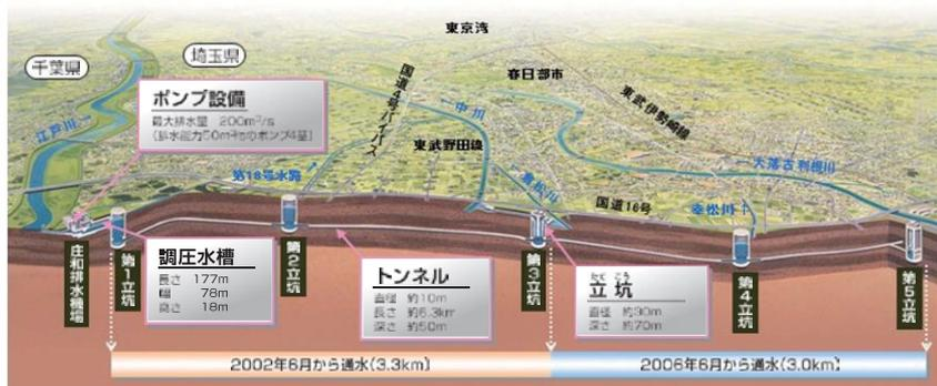
▲国道16号線直下に5基の立坑と6.3kmのトンネル
