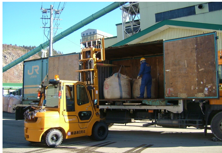
セメント工場へ発送されるガラスカレットの積み込み
