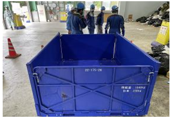
3 m³折り畳みコンテナ組み立て完了
