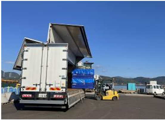
3 m 3 折り畳みコンテナの積替え 1
