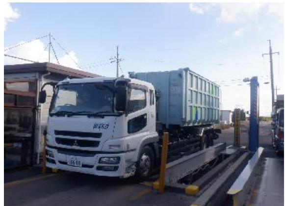
処理施設搬入時の計量（28 m 3 アームロール車）
