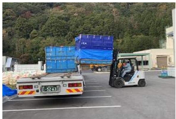
フォークリフトで十輪ユニック車に積込
