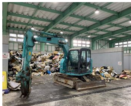
積込に使用したバックホウ（アイアンフォーク）
