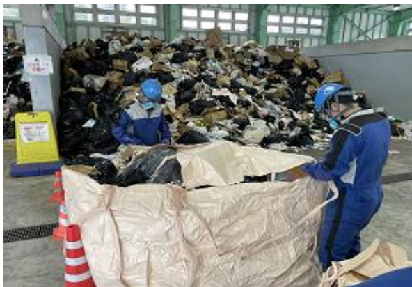
3 m 3 フレコンバッグ梱包作業 (ケース J)
