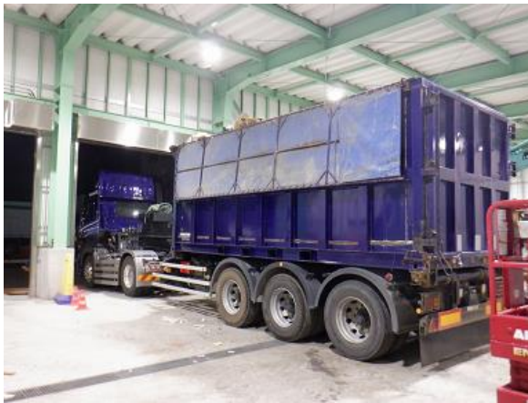
積込作業中の 26 m 3 トレーラー車
