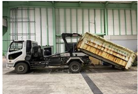
ヤード内からアームロール車による搬出
