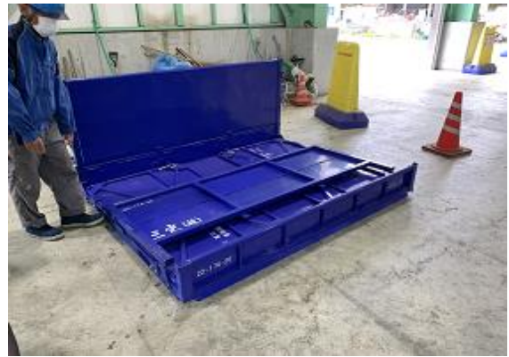
3 m³折り畳みコンテナ組み立て中 1
