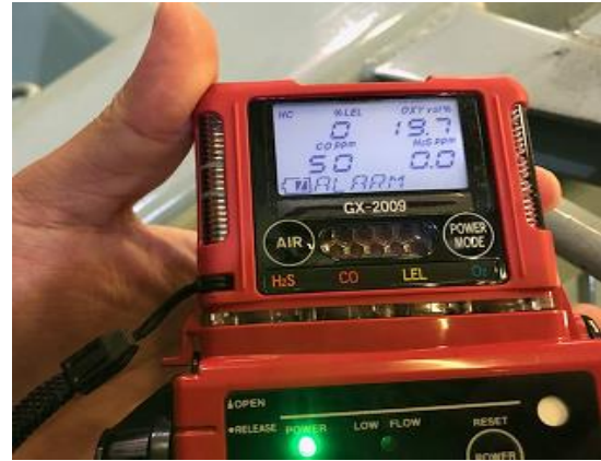
可燃性ガス計測器の計測値の表示
