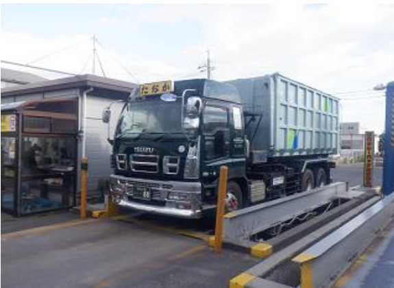
処理施設搬入時の計量（56 m 3 フルトレーラー1/2）
