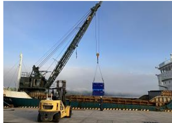
3 m 3 折り畳みコンテナの荷下ろし
