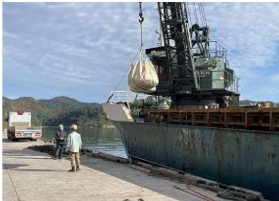
1 m 3 フレコンバッグの積込 2
