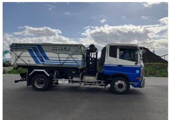
アームロール車への積替え完了
